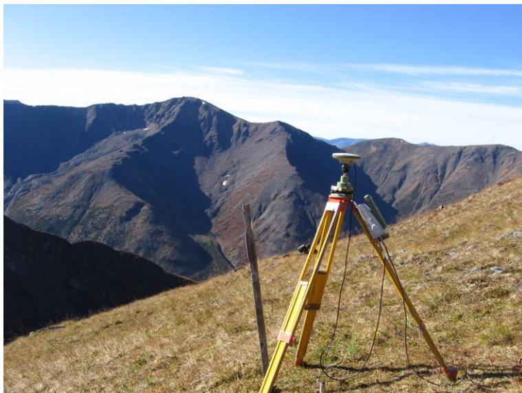
Unité GPS effectuant la collecte de données afin de déterminer la position d'une borne d'arpentage (photo courtoisie de Challenger Geomatics)
