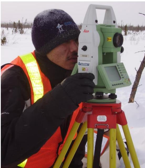
Un technicien en arpentage de Challenger Geomatics installant une station totale (photo courtoisie de Challenger Geomatics)
