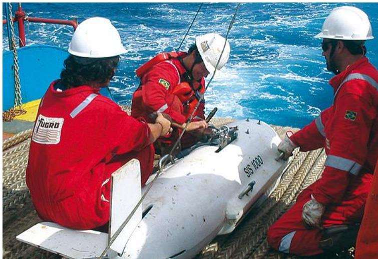
Hydrographes préparant un ROV (véhicule télécommandé) pour un levé (photo courtoisie de Fugro)
